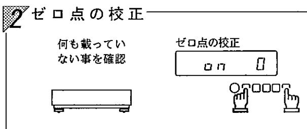
CALキーを押したまま表示切替キーを押し、両方同時に離します。
