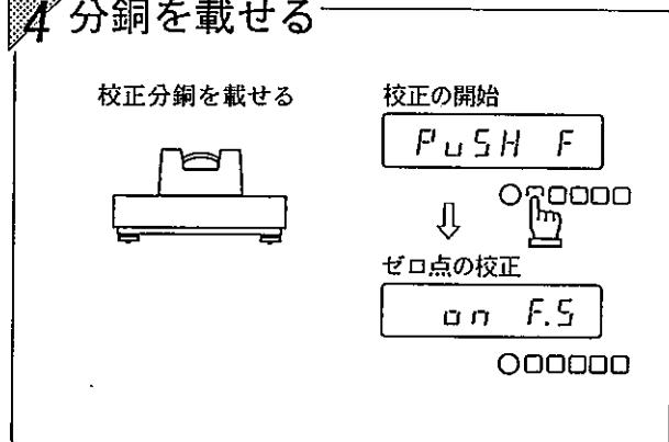
校正分銅を載せ始めると、表示が『PUSH F』に変わります。分銅を載せ終えたら、**表示切替**キーを押すと『ロフ F.5』表示の点滅に変わり、ひょう量点を自動校正します。
