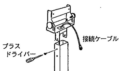
接続ケーブルを通します。表示ステーの向きに注意し、ポールに取付けます。
