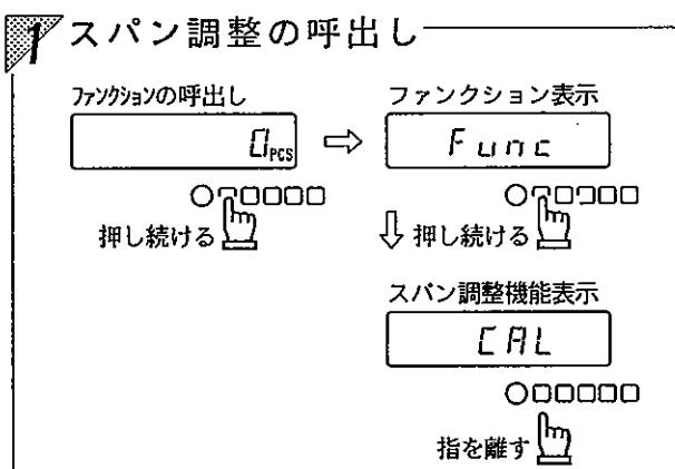
『Func』から『CAL』表示に変わるまで、表示切替キーを押し続けます。
