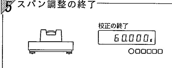
ひょう量点の校正が終わると、元の測定モードに戻ります。
