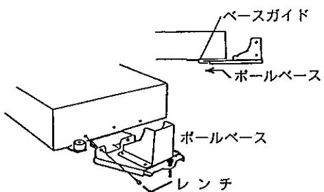
付属のポールベースを計量部の底面のベースガイドに合わせ、付属のレンチで取付けます。計量部底面のガイドに、ポールベースを確実に差し込んでください。
