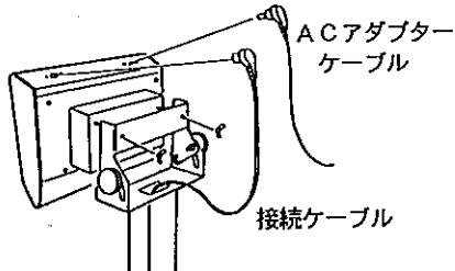
表示ステーに表示部を取り付け、接続ケーブルとACアダプターを接続します。
