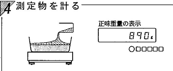
引き続き**[計量]**と同様、測定物を入れ追加量のみを計量します。
