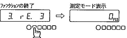
表示切替キーを押し続けると、最終機能項目が表示された後、元の測定モードに戻ります。
