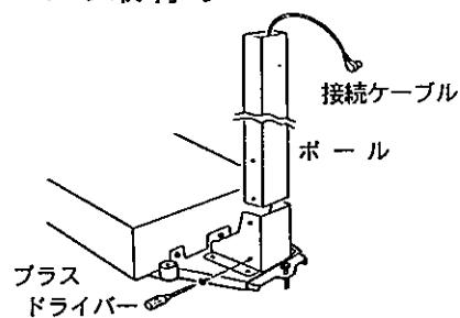
接続ケーブルを、ポールの下側(取付け穴幅の広い方)から通します。次に、ポールの下側をポールベースに取付けます。
