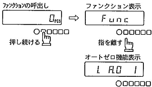
表示切替キーを4秒位押し続け、表示が『Func』に変わった時に指を離します。
